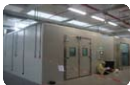
长寿命试验(40°C, 满载, 测试180天)
